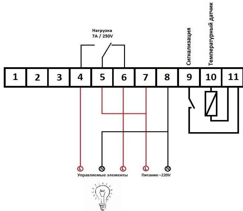
Схема подключения терморегулятора LILYTECH ZL-6210A(30A)
